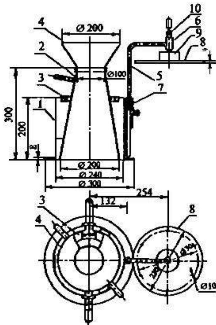
1 - цилиндр с фланцем в основании; 2 - конус; 3 - кольцо-держатель с ручками; 4 - загрузочная воронка; 5 - штатив; 6 - направляющая втулка; 7 - фиксирующая втулка; 8 - диск с шестью отверстиями; 9 - стальная шайба; 10 - штанга
