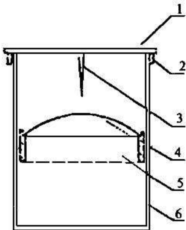
1 - металлическая пластина; 2 - ограничители; 3 - стрелка; 4 - петля; 5 - пригружающий пуансон; 6 - цилиндрический сосуд
